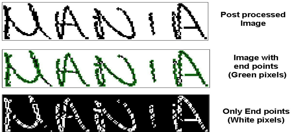
Σχήμα 3-16: Παράδειγμα των τελικών σημείων (End Points) της λέξης “MANIA”. Στην μεσαία εικόνα τα pixel που αναπαριστούν End Points σημειώνονται με πράσινο χρώμα ενώ η κάτω εικόνα δείχνει μόνο τα End Points (άσπρα pixel).
